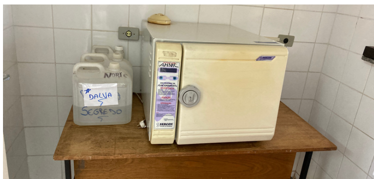
Foto 9 - Autoclave em desuso por falta de manutenção
